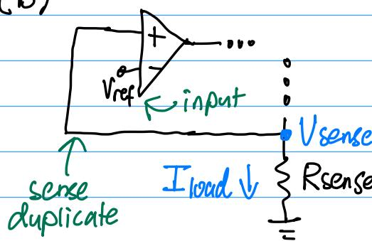
$$\text{Notice } V_{\text{sense}} = I_{\text{load}} R_{\text{sense}}$$
