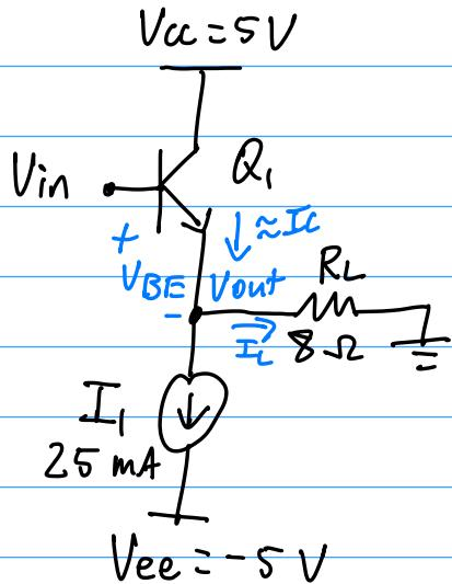
$$I_C = I_{S1} e^{\frac{V_{BE}}{V_T}}$$
